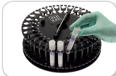
Закрытая **пробирка PENOK** может быть загружена непосредственно в роторы анализаторов **Alfred 60** и **Sidecar** для полной автоматизации анализа до **60 проб** одновременно.
