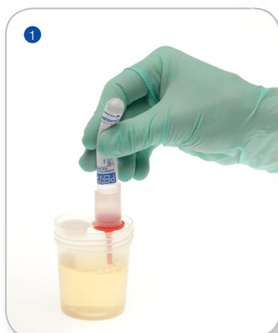
1. Сжать корпус пробирки PENOK и погрузить кончик пипетки в пробу. Аккуратно отпустить корпус.
