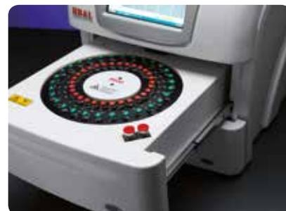
Ротор HB&L с инокулированными флаконами.
