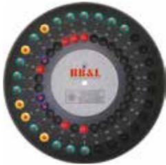
Запатентованная технология, основанная на методе лазерного светорассеяния, позволяет обнаружить с высокой чувствительностью и специфичностью наличие бактерий в пробе и определить их устойчивость к антибиотикам.
