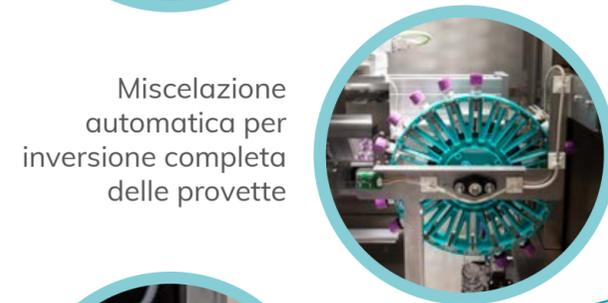
Miscelazione automatica per inversione completa delle provette
